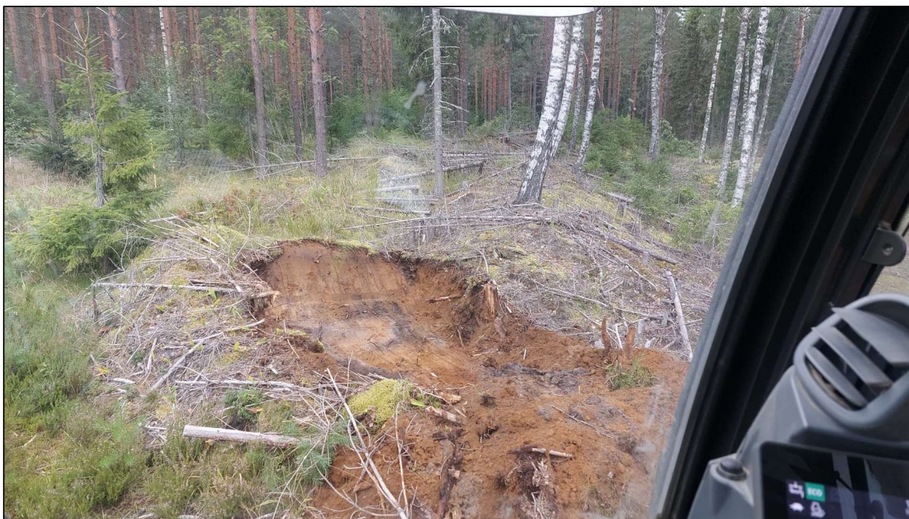
Kuva 2. Koekuoppa läntisimmästä kuopasta. Pinnassa on noin 30-40 cm kerros sekalaista pintamaata. Selkeää rikastumiskerrosta ei näy, vaan maakerrokset ovat sekoittuneet. Tälle alueelle tulee vanha traktorinura tien suunnasta luoteesta.
