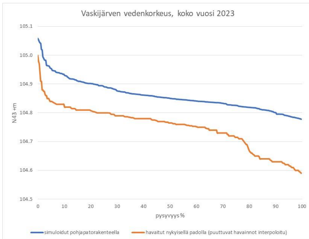
Kuva 15. Vaskijärven vedenkorkeudet simuloidulla pohjapatorakenteella keskivesitasolla +104,84 m vuodelta 2023 ja havaitut vedenkorkeudet vuodelta 2023
