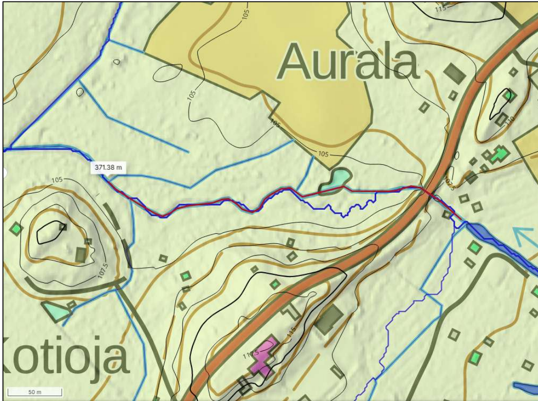
Kuva 7. Kalataloudelliseen kunnostukseen potentiaalinen padon alapuolinen uomaosuus. Uomaosuuden (liila korostus) pituusleikkaus on esitetty kuvassa 8.
