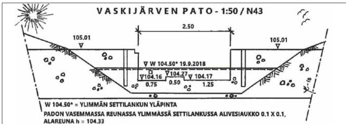
Kuva 7. Vaskijärven padon mittakuva (Kuvaja 2018 7 , Maveplan Oy 2024 8 ).
